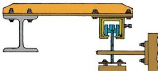
Подвесы устанавливаются из расчета 3 шт на 1 секцию С-образного профиля:
