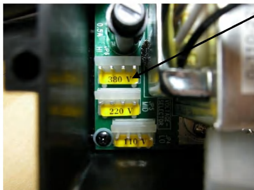
Переключатель для выбора напряжения питания приемника
